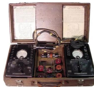
Weston buizen combinatie tester uit 1940 met buisvoet adapters.
