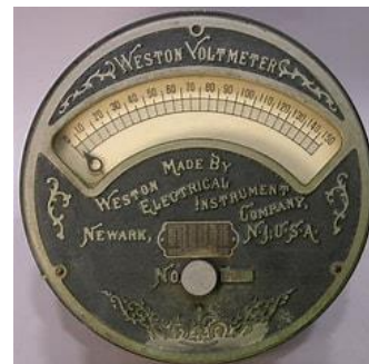
Een vroege Weston draaispoelmeter
