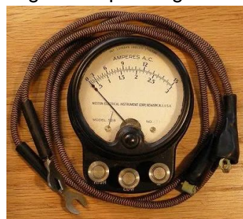
Een Weston zakmeter 528-serie voor elektriciens.
