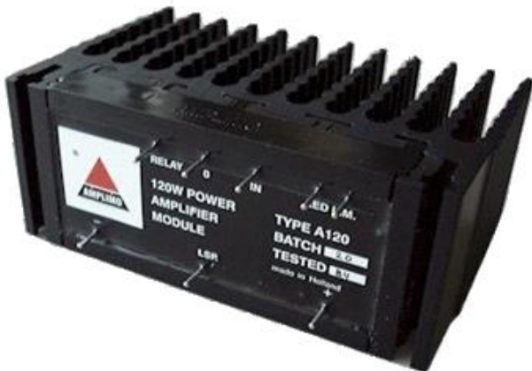
Afbeelding 4 Een 120 W versterker Amplino gemaakt volgens de dunne filmtechniek.
