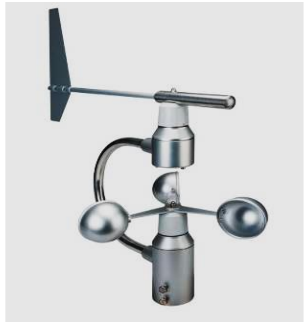
Afbeelding 5, De beroemde Thies windsnelheid/-richting meter.
