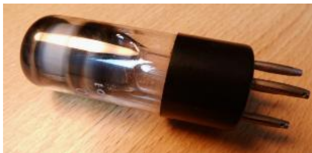
De special RAF stabilisatiebuis
